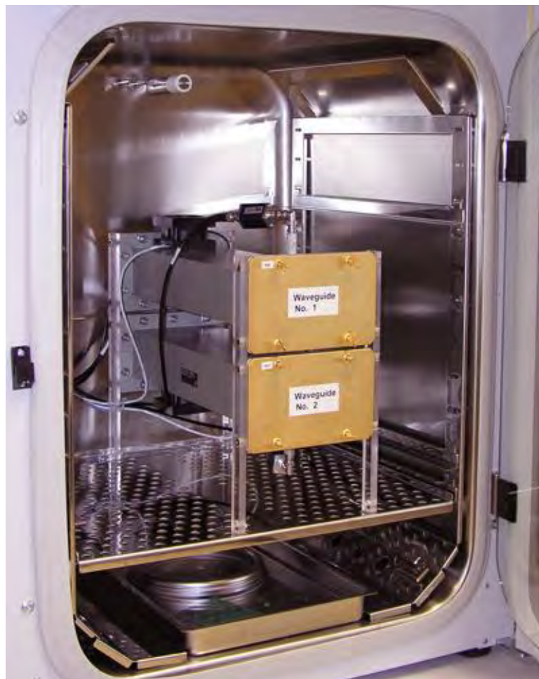
Abb. 5.1: Beispiel einer Expositionsanlage mit zwei Kammern (Waveguide 1 & 2) für die zeitgleiche reale Exposition und Scheinexposition (unbestrahlte Kontrolle)
