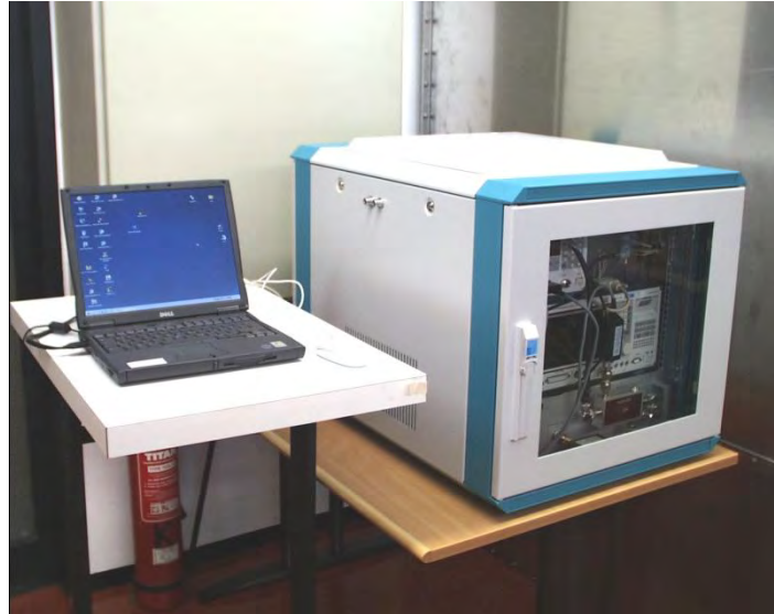
Abbildung 2.14: Signalerzeugung und Notebook mit Steuersoftware
